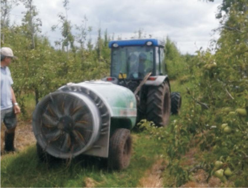
*Figura 5: pulverizador de flujo axial o "atomizadora común" (D)*
