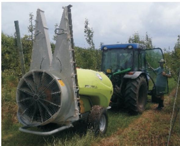
*Figura 3: pulverizador de flujo tangencial o torre (B)*
