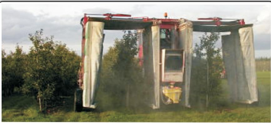
Figura 2: pulverizador de pantalla o túnel (A) (TOPPS Prowadis, 2014)
