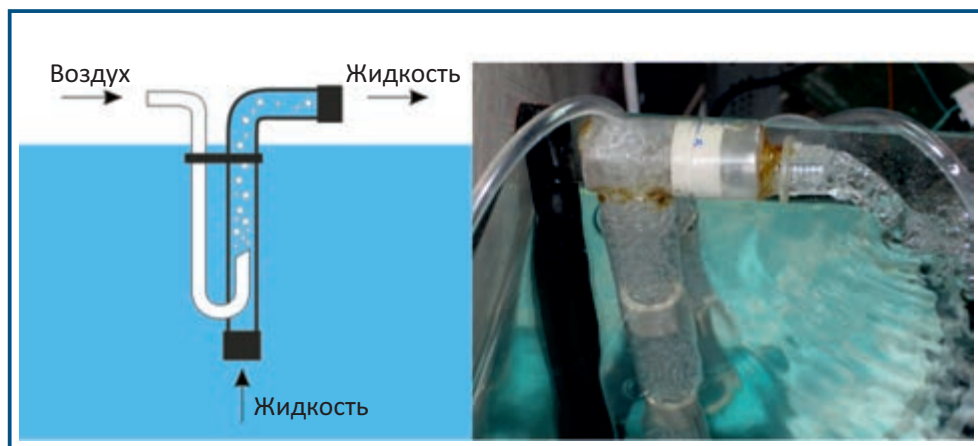
Рис. 7. Эрлифт: схема работы (слева) и работающий образец (справа)
