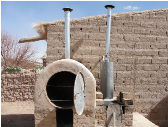
Cocina y Horno ahorradores de leña. Con termotanque de agua. Proyecto de la Comunidad Aborigen de Pozo Colorado, Jujuy.
